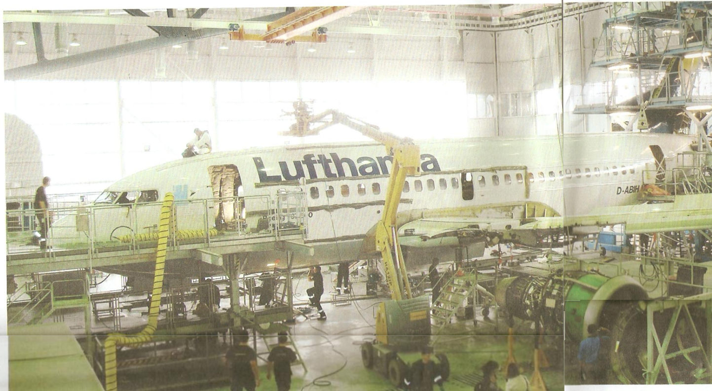
В Луфтханза Техник София разполагат с две линии за ремонт. Едната е запазена специално за Луфтханза и на нея се ремонтират само самолети на компанията. Другата линия е за всички останали клиенти. Двете линии са абсолютно еднакви като размер и като оборудване
